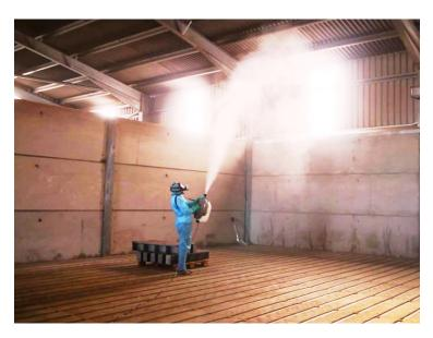
Получающийся размер капель аэрозоли у генераторов горячего тумана: 5-30 микрон, у генераторов холодного: 40-80 микрон. Если сравнивать с обычным опрыскивателем, где получается размер капель в сотни микрон, оба этих способа весьма эффективны. Однако, горячий туман оседает медленнее холодного, проникает глубже в самые маленькие щели и труднодоступные полости в помещении.
